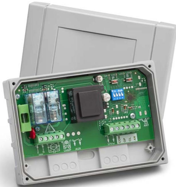
Centralina di comando per tende da sole con anemometro.
