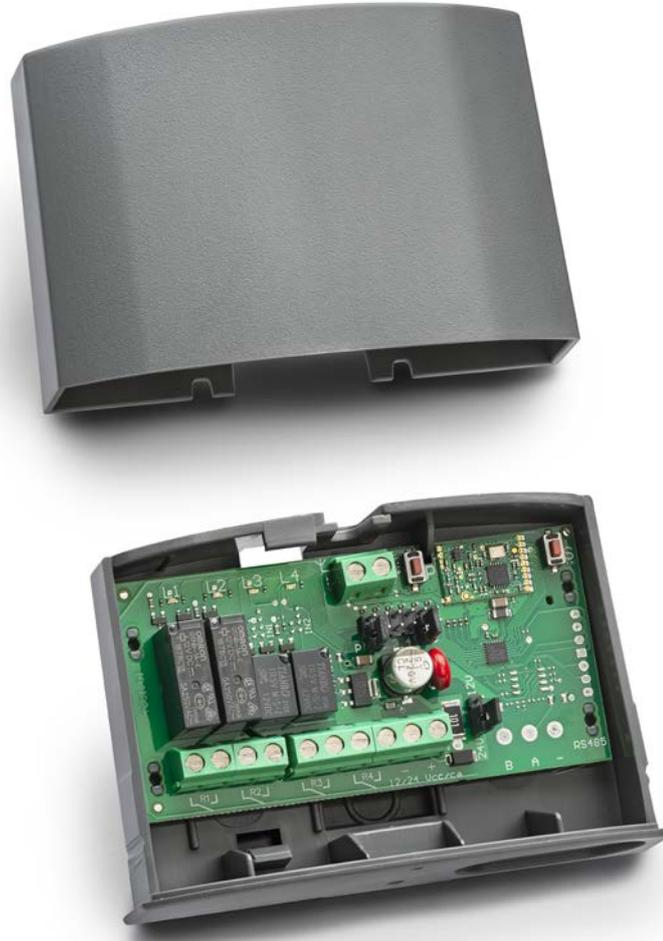
Ricevitore professionale multifrequenza da 433 a 868 MHz a 2 o 4 canali.
