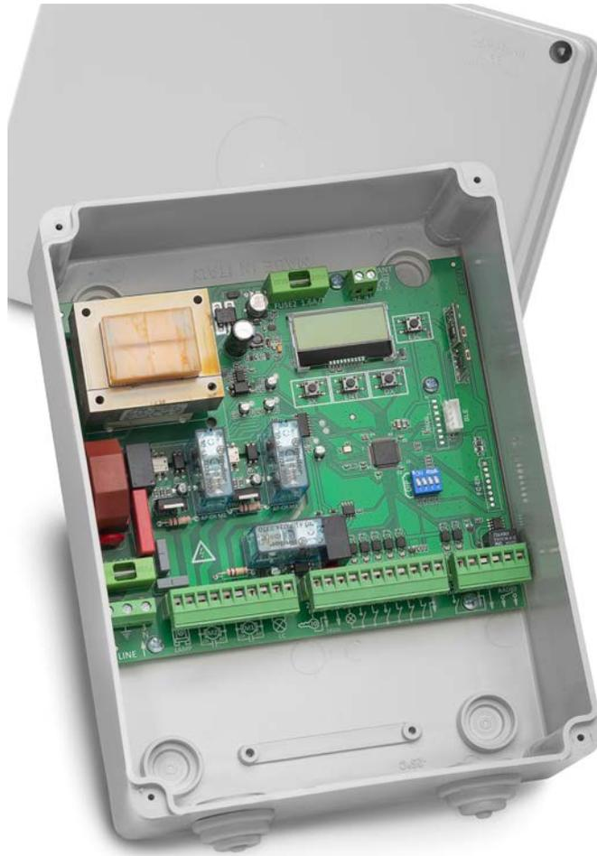
Centrale universale di comando per motori 230 Vac per cancelli scorrevoli, a battente, a una o due ante, con o senza finecorsa.
