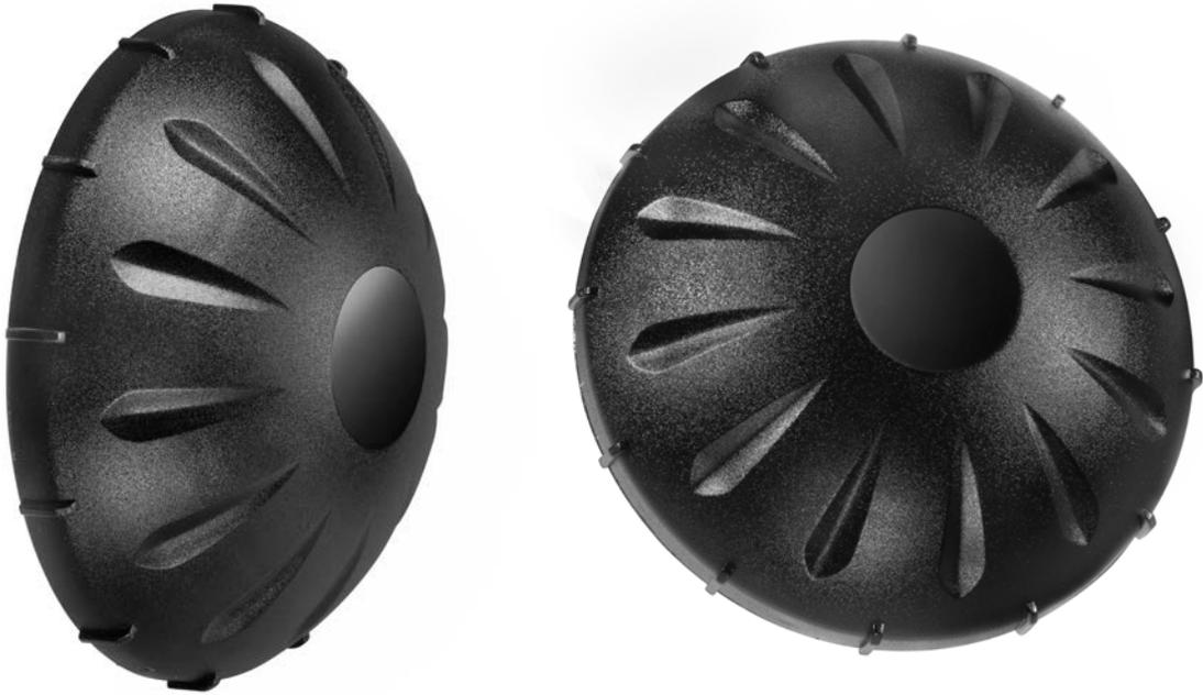
Diametro  $\varnothing$  88 mm con nuova tecnologia ottica ad infrarossi, alimentabile a 12/24 Vac/Vdc con selezione automatica, elevata protezione contro i raggi diretti del sole, lampade e altre fonti luminose o di calore. Involucro plastico contro l'infiltrazione di acqua o di insetti e contro le interferenze RF. Stabilità e affidabilità anche in condizioni climatiche estreme.
